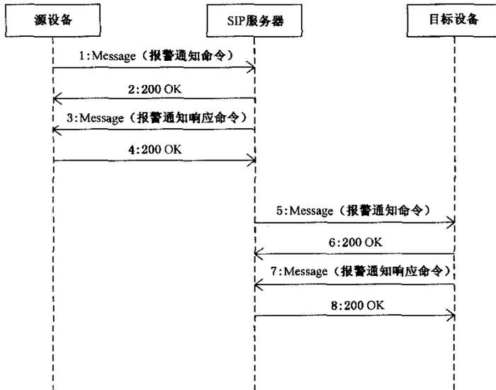
图 15 报警事件通知和分发流程示意图
