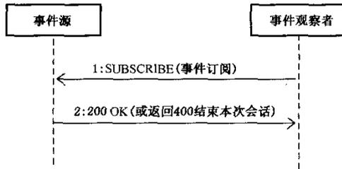
图 23 事件订阅流程示意图
