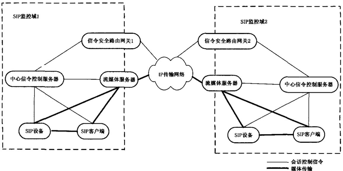
图 1 SIP 监控域互联结构示意图
