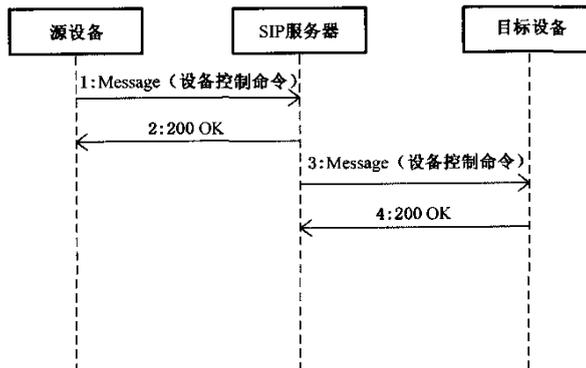
图 13 无应答设备控制流程示意图
