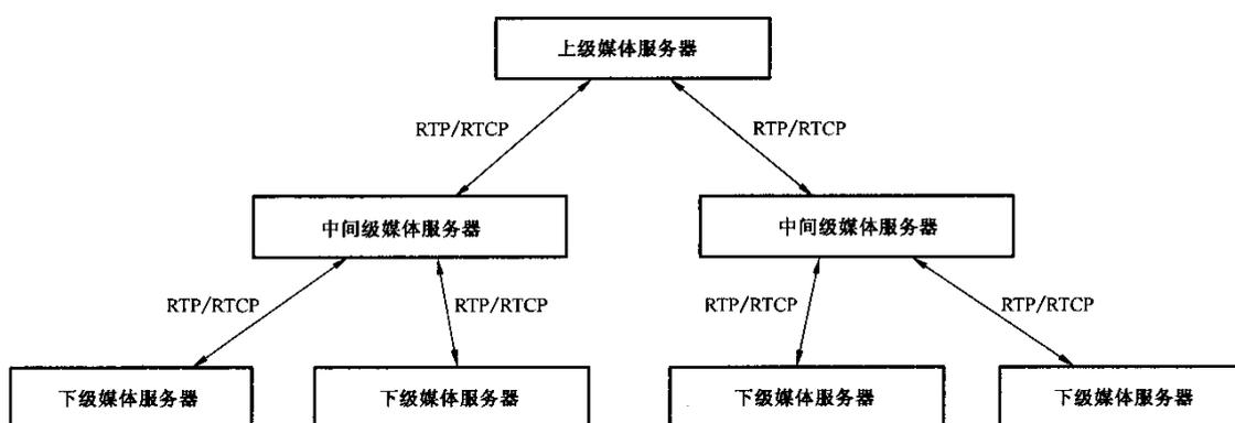
图 3 媒体级联结构示意图
