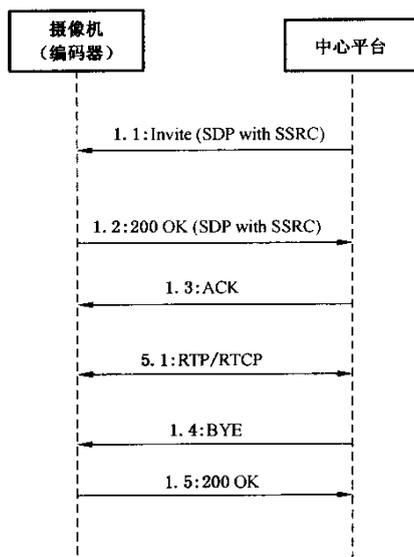
图 F.1 点播、回放、下载的流程示意图
