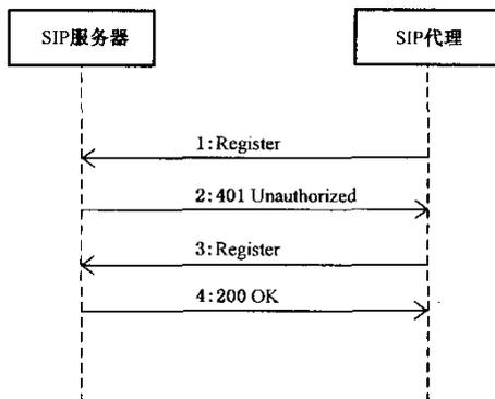
图 8 基本注册流程示意图
