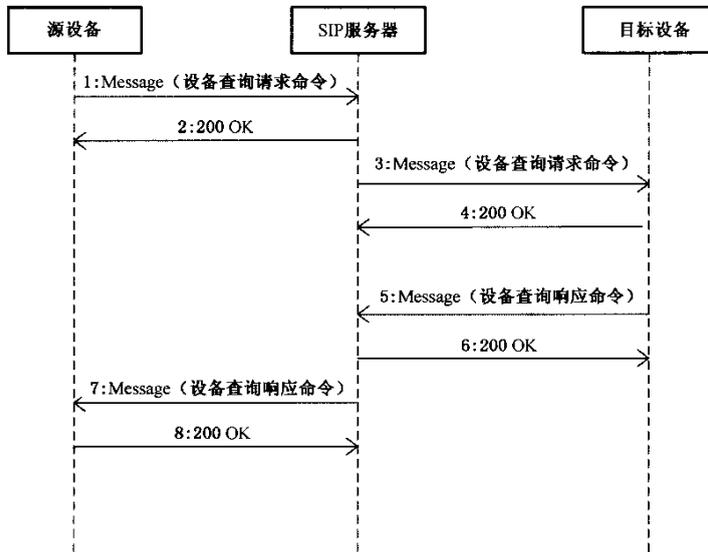
图 16 网络设备信息查询流程示意图
