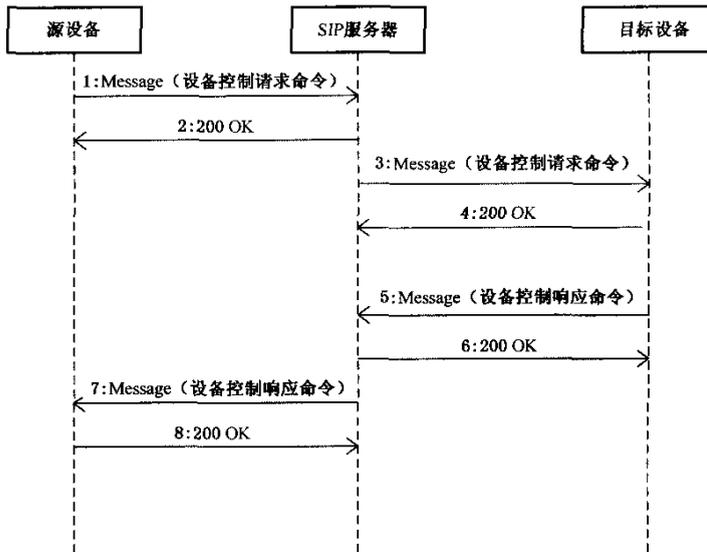
图 14 有应答设备控制流程示意图
