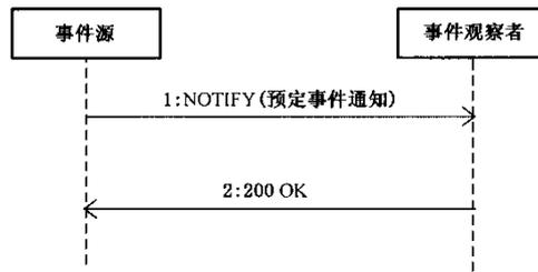
图 24 事件通知流程示意图
