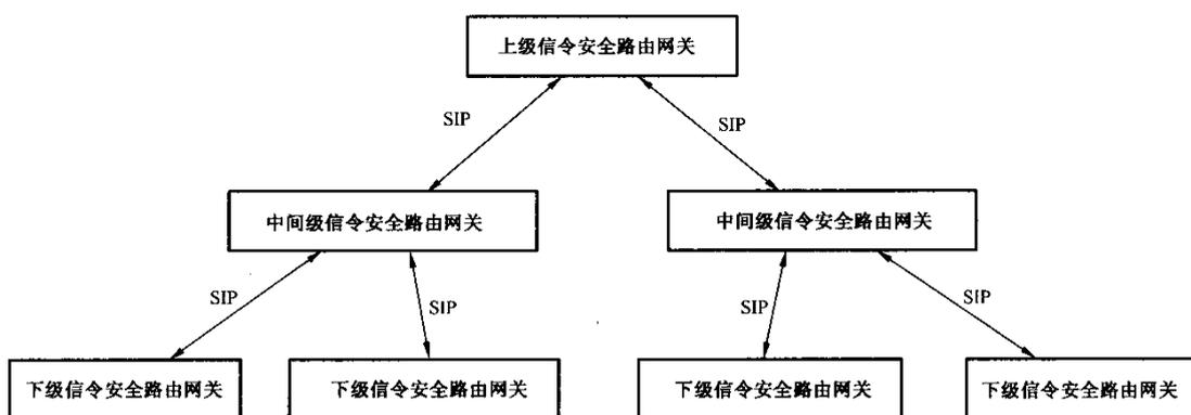
图 2 信令级联结构示意图
