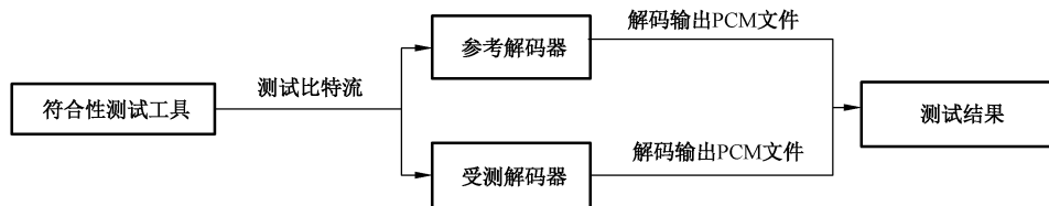
图 9 各档次音频解码器测试流程
