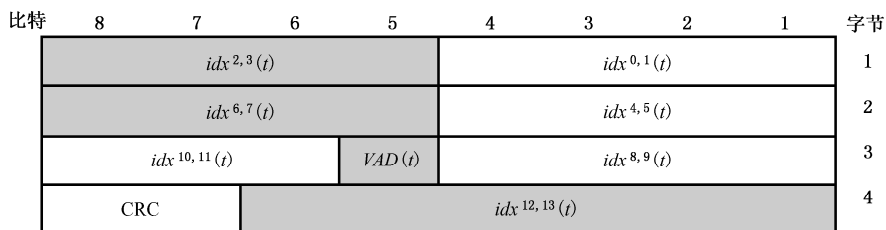
图 54 预测编码模式帧的数据格式(32 比特)
